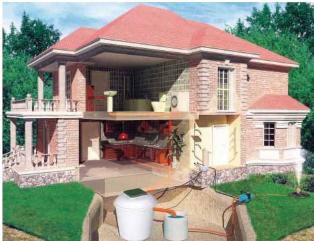
Schematické znázornění čištění a využití odpadních vod u rodinného domu. Foto archiv USBF Technology
