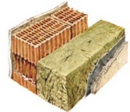
Masivní cihlová zeď s 25 cm nalepené minerální izolace na vnější straně.
