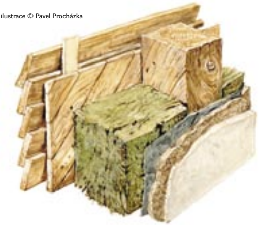
Lehká dřevěná konstrukce vyplněná minerální vatou.
