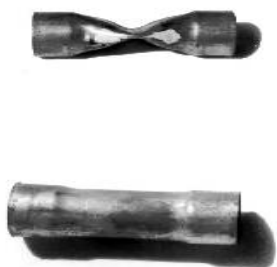
Obr. 36: Objímka se zaškrcením a distanční objímka
