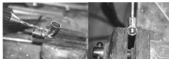
Obr. 34 Výroba objímky pro čidlo (skutečná mufna se z ní vyrobí roztažením konců trubky speciálním nástrojem)
