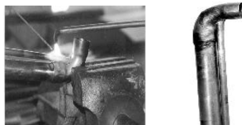
Obr. 35 Alternativní umístění trubky pro čidlo do kolena
