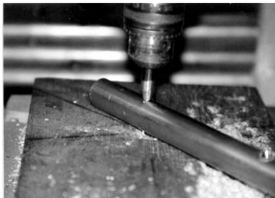
Obr. 31 Rozšíření sběrné trubky jednoduchým speciálním nástrojem
